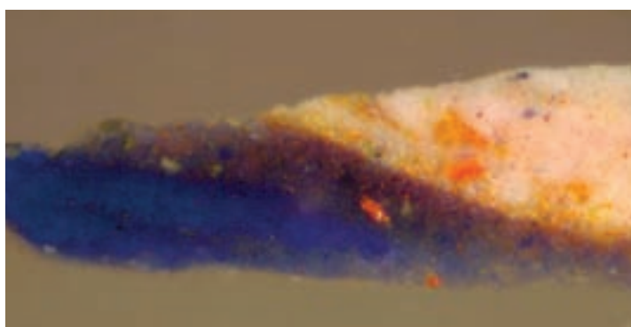
Fot. 563. Przekrój poprzeczny próbki ciemnego różu z obrazu Piazza del Popolo w Rzymie w świetle VIS. W próbce występują: błękit kobaltowy ( CoO \cdot Al_2O_3 ), biel Pattinsona ( Pb(OH)_2 \cdot PbCl_2 ) (?), żółcień strontowa ( SrCrO_4 ) i cynober ( HgS ) (fot. E. Doleżyńska-Sewerniak)
