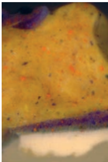
Fot. 537, 538. Przekrój poprzeczny próbki żółcieni z obrazu Pinie przy Villa Borghese w świetle VIS i w technice fałszywych kolorów. W kolorowej podczerwieni kolorystyka próbki uległa zmianie. Kolor czerwony zmienił się w żółty, błękit w czerwień, żółcień w biel, zieleń w fiolet. W próbce zidentyfikowano głównie cynober ( \text{HgS} ), błękit kobaltowy ( \text{CoO}_3 \cdot \text{Al}_2\text{O}_3 ), żółcień strontową ( \text{SrCrO}_4 ) i zieleń szmaragdową ( \text{Cr}_2\text{O}_3 \cdot 2\text{H}_2\text{O} ) (fot. E. Doleżyńska-Sewerniak)
