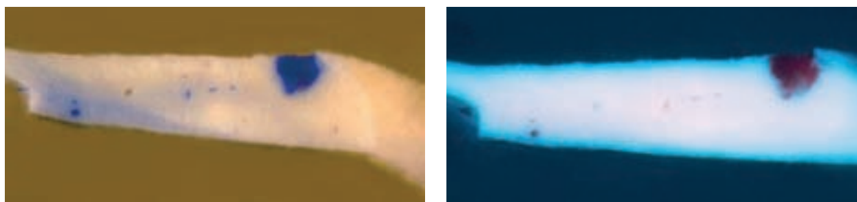
Fot. 509, 510. Przekrój poprzeczny próbki błękitu z obrazu Ogrody w Tivoli w świetle VIS, w technice fałszywych kolorów (fot. E. Doleżyńska-Sewerniak). Jasnoniebieski kolor artysta uzyskał, mieszając błękit kobaltowy ( \text{CoO} \cdot \text{Al}_2\text{O}_3 ) z bielą ołowiową ( 2\text{PbCO}_3 \cdot \text{Pb}(\text{OH})_2 )
