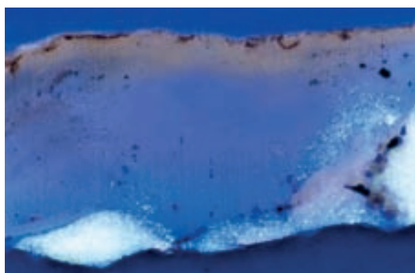
Fot. 101–104. Przekroje poprzeczne próbek warstw malarskich z obrazów Aleksandra Gierymskiego w świetle VIS i UV ukazujące nadmiar spoiw i ich fluorescencję w UV. Od góry: W altanie (1876–1880) i Opera paryska w nocy (1891) (fot. Z. Rozłucka)
