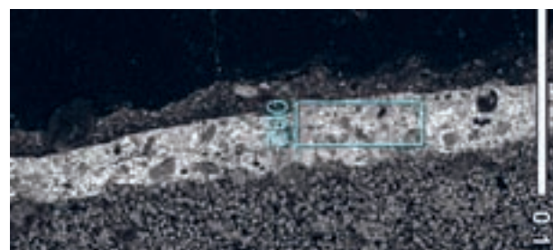
Fot. 277, 278. Przekrój poprzeczny próbki żółci obrazu Studium I. Zdjęcie w świetle VIS (fot. E. Doleżyńska-Sewerniak), zdjęcie skaningowe (SEM) w świetle elektronów odbitych (BEI). Niebieskim prostokątem zaznaczono obszar analizy warstwy zielonej (fot. M. Wróbel):
