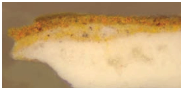
Fot. 481. Przekrój poprzeczny próbki czerwieni z obrazu Wnętrze kościoła św. Włonganga w Rothenburgu: Warstwa biała: biel ołowiowa ( 2PbCO_3 \cdot Pb(OH)_2 ), biel cynkowa ( ZnO ), kreda ( CaCO_3 ) Warstwa żółta: biel ołowiowa ( 2PbCO_3 \cdot Pb(OH)_2 ), żółcień żelazowa ( Fe_2O_3 \cdot nH_2O ), żółcień chromowa ( PbCrO_4 ), żółcień kadmowa ( CdS ) Warstwa czerwona: cynober ( HgS ), żółcień kadmowa ( CdS ), żółcień żelazowa ( Fe_2O_3 \cdot nH_2O ), żółcień chromowa ( PbCrO_4 ), czerwień chromowa ( PbCrO_4 ), siarczan baru ( BaSO_4 ) jako wypełniacz (fot. E. Doleżyńska-Sewerniak)
