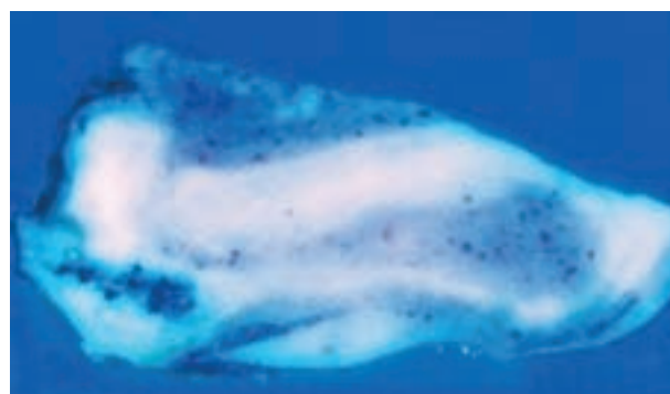
Fot. 467, 468. Przekrój poprzeczny próbki zieleni z obrazu Mury obronne w Rothenburgu w świetle VIS i CIR. Na podstawie szczegółowych badań fizyko-chemicznych w próbce zidentyfikowano mieszaninę żółcień strontowej ( \text{SrCrO}_4 ) z bielą ołowiową ( 2\text{PbCO}_3 \cdot \text{Pb}(\text{OH})_2 ) i zielenią szmaragdową ( \text{Cr}_2\text{O}_3 \cdot 2\text{H}_2\text{O} ) oraz niewielki dodatek czerni kostnej (fot. E. Doleżyńska-Sewerniak)
