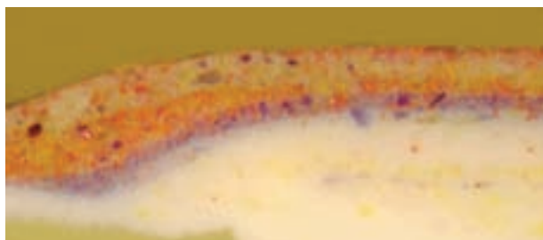
Fot. 501, 502. Przekrój poprzeczny próbki czerwieni z obrazu Ogrody w Tivoli w świetle VIS i w technice fałszywych kolorów. Pigment czerwony uległ zamianie w czerwień, co świadczy o występowaniu w tym fragmencie cynobru. Kolor niebieski z kolei zamienił się w czerwień. Potwierdza to występowanie błękitu kobaltowego (fot. E. Doleżyńska-Sewerniak)
